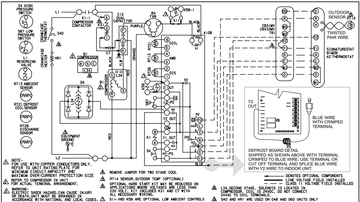
Figure 27. XP16 Wiring
